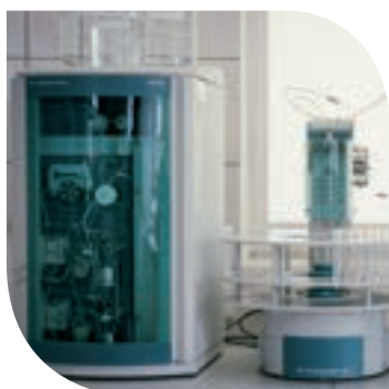
Zintegrowany system Metrohm w skład którego wchodzi chromatograf jonowy 940 Professional IC Vario w kompilacji z chromatografem cieczowym 930 Compact IC Flex
